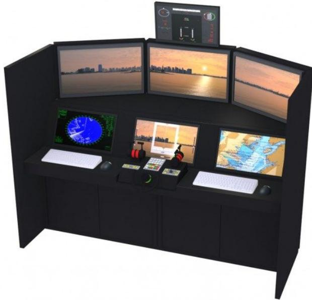
**IBS (Integrated Bridge System) - Интегрированная Мостиковая Система** - это сопряженные в единый комплекс системы судовождения и управления судном с целью повышения эффективности обработки информации и управления судном, обеспечивающий повышение навигационной безопасности плавания.
