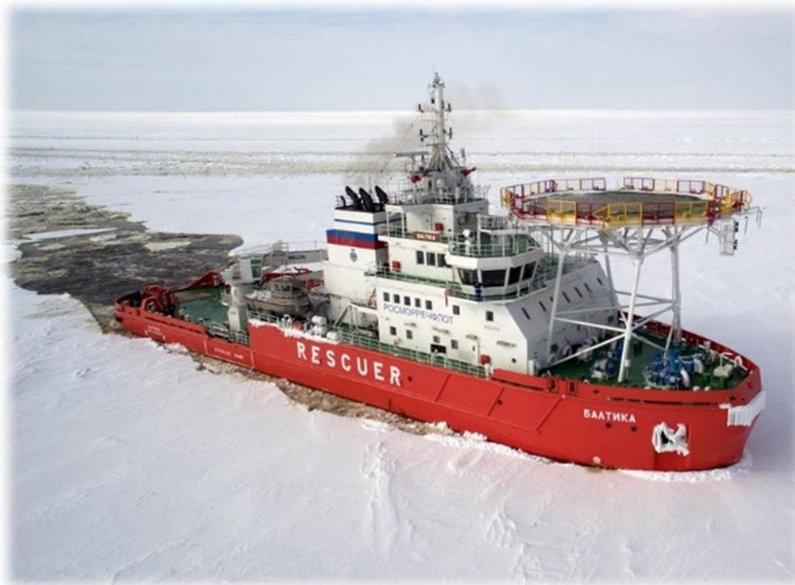
➤ Многофункциональное аварийно-спасательное судно ассиметричный ледокол «Балтика»
