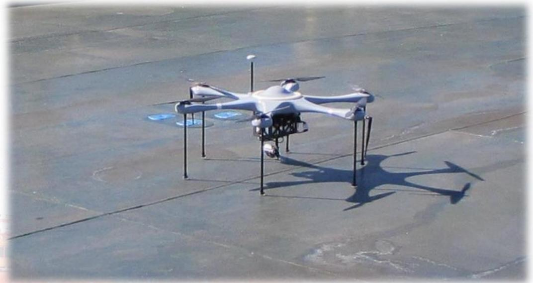
Рисунок 5. Комплекс удаленного мониторинга на базе беспилотного устройства вертолетного типа RAL X6TM
